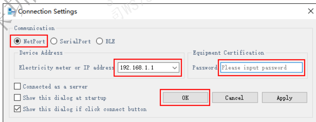
图3-10 网口连接设置示意图
